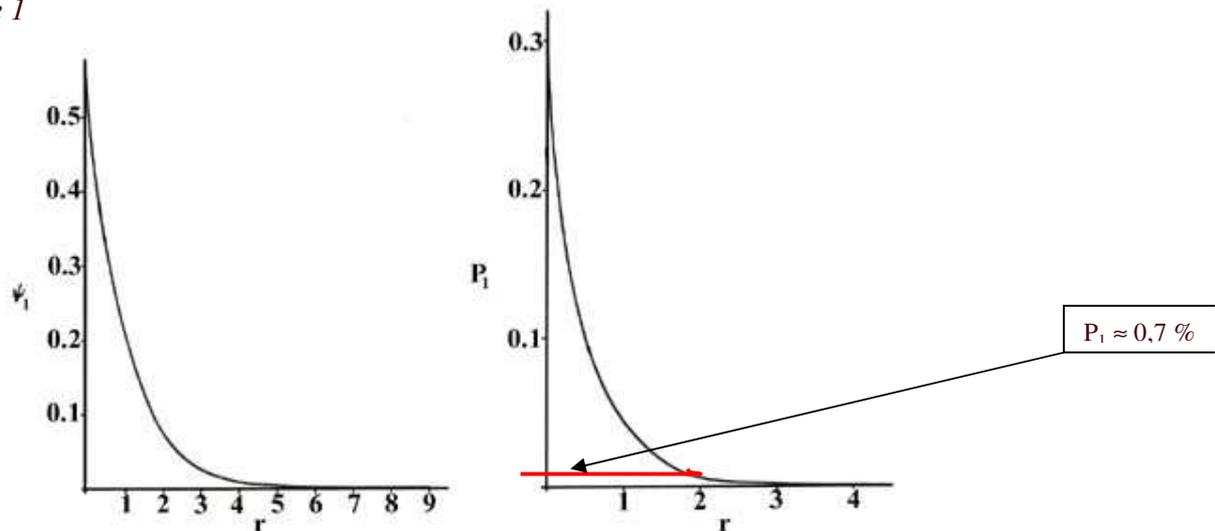
On voit ici 2 graphiques, le premier représentant la fonction d'onde  $\Psi$  de l'électron de l'atome d'hydrogène au niveau d'énergie  $n = 1$  en fonction de la position  $r$  de l'électron<sup>4</sup> et le second nous donnant la probabilité de trouver l'électron à une position  $r$ .
